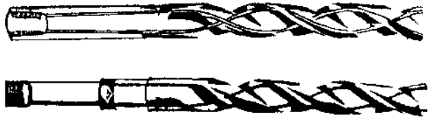
Hình 9.40. Mũi khoan ruột gà có lỗ dẫn dung dịch trơn nguội
