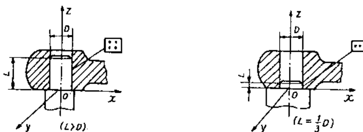
Hình 5.12. Khối V ngắn khống chế 2 bậc tự do \vec{o}z, \vec{o}y .
