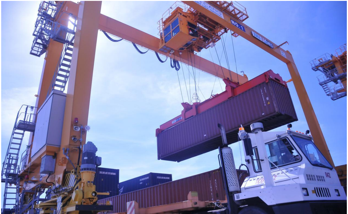
Hình 1.8: Hình ảnh cầu khung RTG và xe đầu kéo
