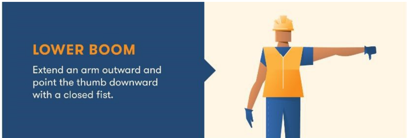
Hình 3.6: Thao tác hạ móc (nguồn :Kiểm định an toàn cầu trực )
