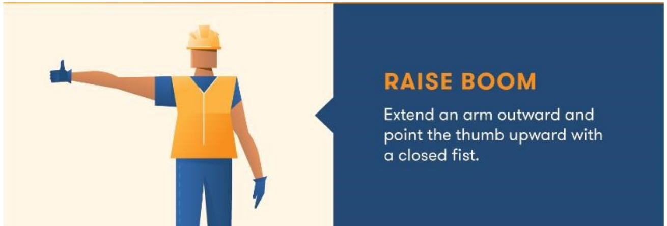
Hình 3.5: Thao tác nâng móc (nguồn :Kiểm định an toàn cầu trực )
