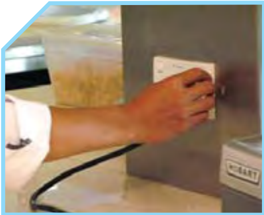
TẮT NGUỒN ĐIỆN TRƯỚC KHI KIỂM TRA
