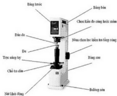
Hình 6.5. Máy đo độ cứng ROCKWELL-ALT-600
