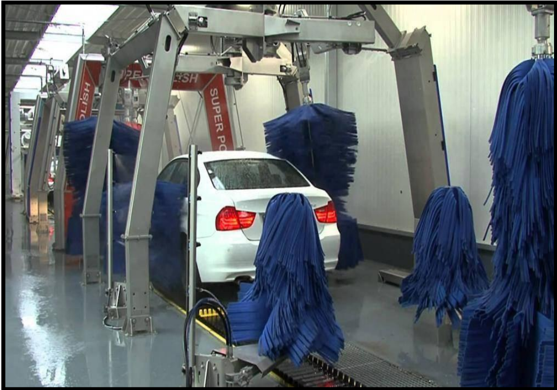
Hình 2.3 Máy rửa xe tự động điều khiển DXC(B)-740.
