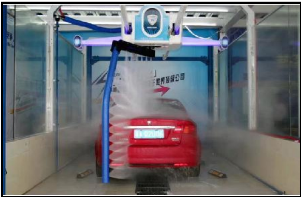
Hình 2.4 Máy rửa xe tự động loại ngoài trời.
