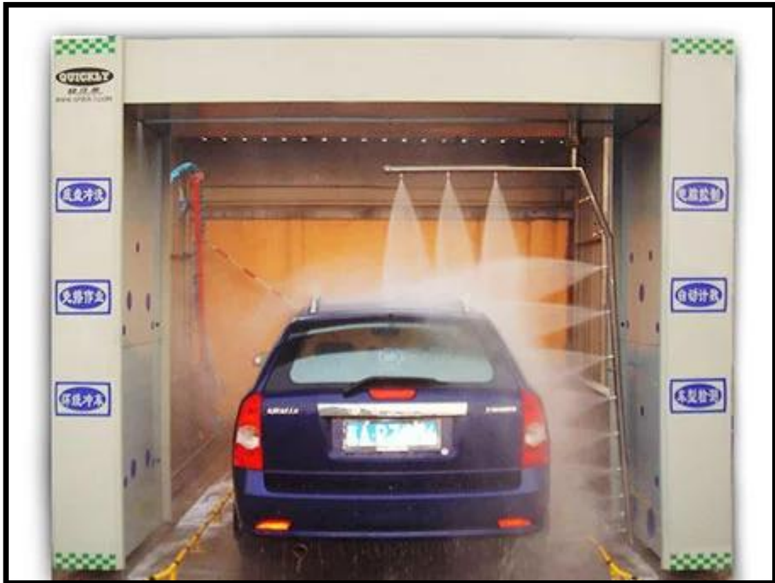
Hình 2.2 Hệ thống phun nước áp lực lớn.
