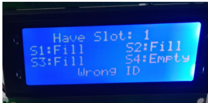
Hình 21. Khi dùng sai thẻ để vào bãi đỗ xe
