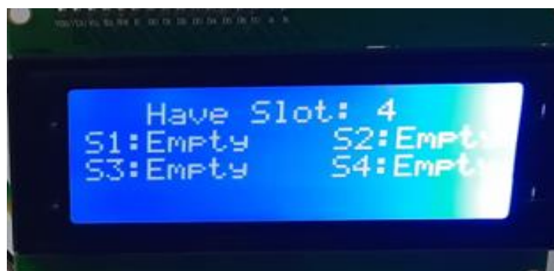
Hình 28. Màn hình hiển thị trạng thái khi toàn bộ xe rời đi
