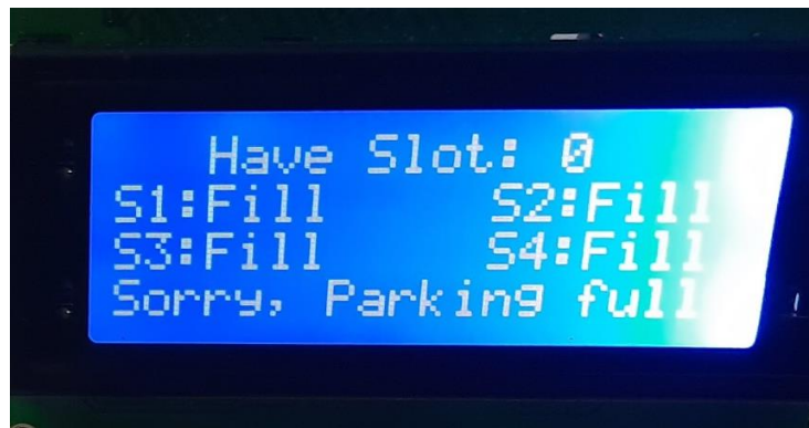
Hình 25. Tình trạng khi có xe muốn vào khi bãi đỗ xe đầy
