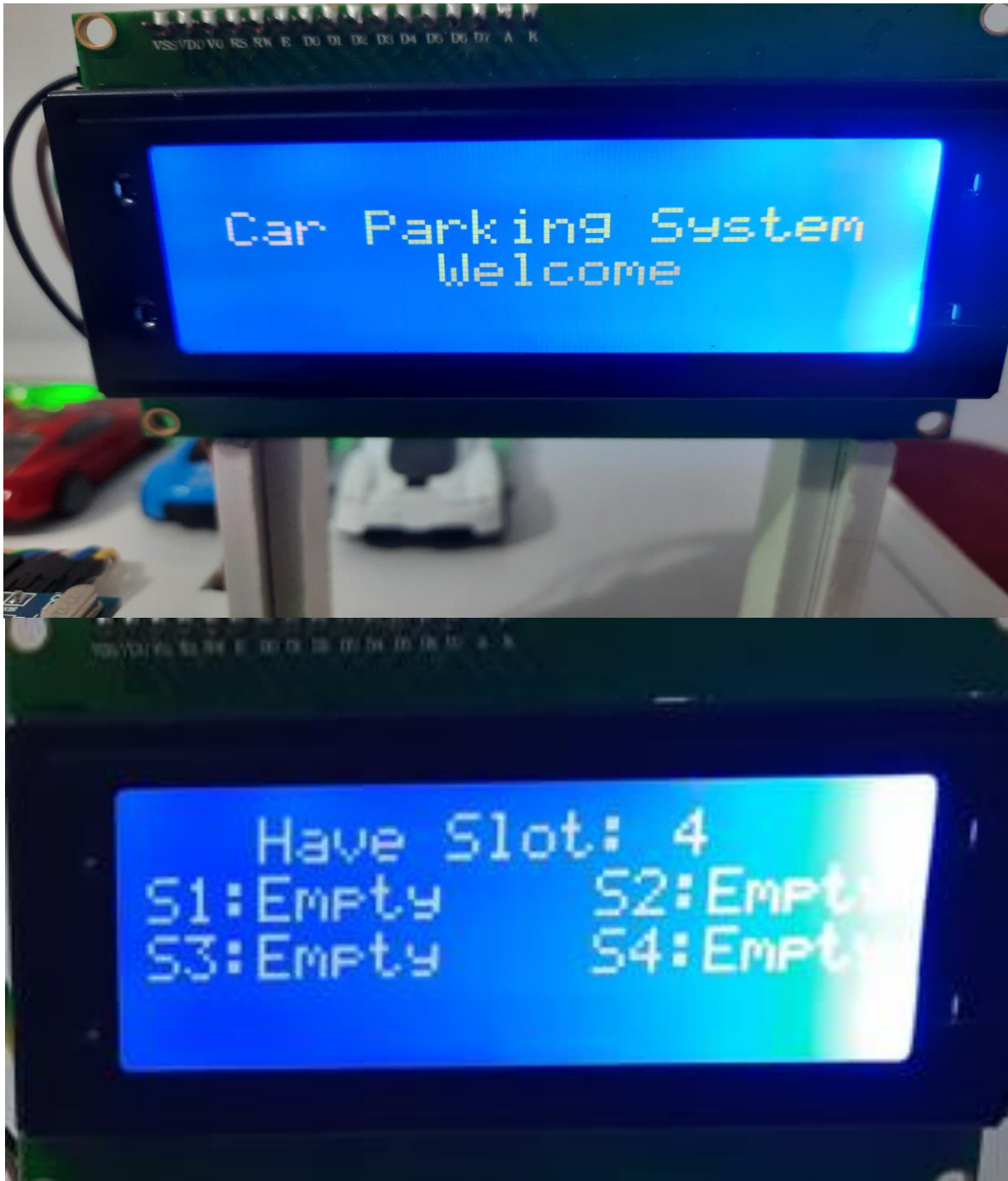
Hình 18. Màn hình LCD khi khởi động hệ thống
