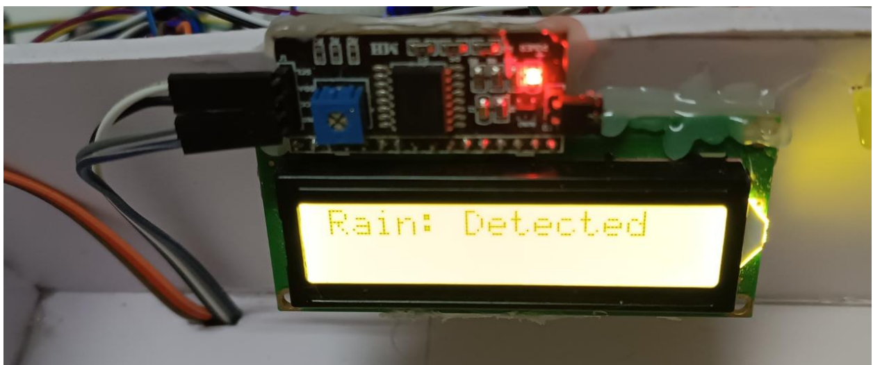
Hình 3.12 LCD thông báo có mưa
