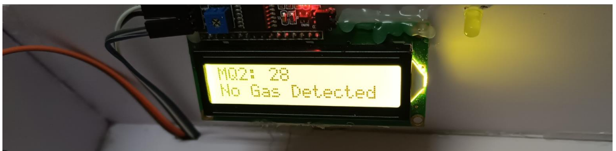
Hình 3.11 LCD báo hệ thống không rò rỉ khí gas
