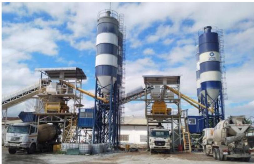
Hình 1.1 Trạm trộn bê tông
