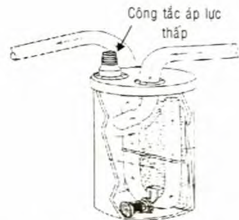
Hình 11.125: Cấu tạo bình tách lỏng
