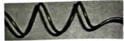
Hình 11.51: Cấu tạo ống mao dẫn
