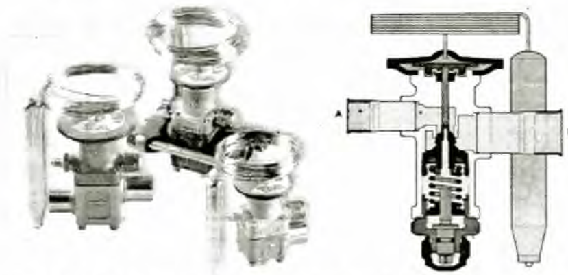
Hình 10.22: Cấu tạo của van tiết lưu tự động bằng bầu cảm biến nhiệt
