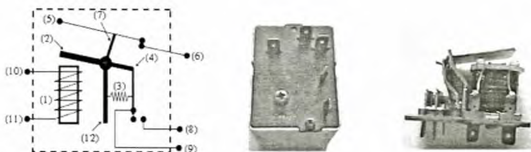
Hình 11.57: Cấu tạo rơ le điện áp
