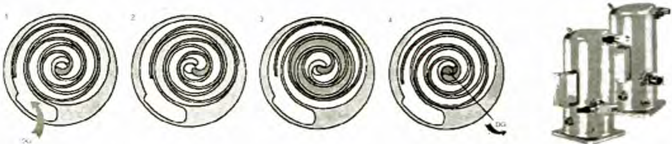
Hình 10.13: Cấu tạo của máy nén rotor kiểu xoắn ốc
