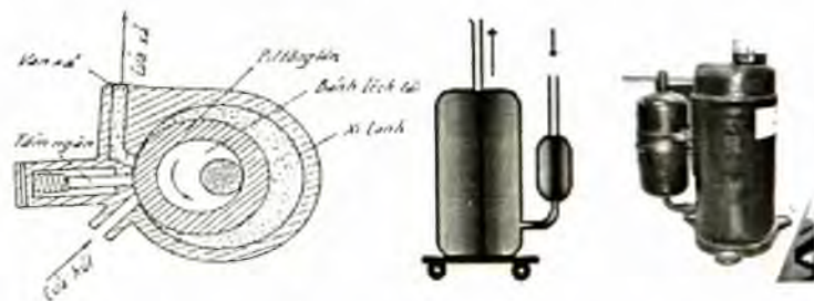
Hình 11.48: Cấu tạo máy nén rotor lăn
