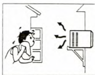
Hình 11.97: Hơi nóng máy lạnh thổi qua nhà bên cạnh
