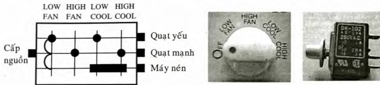
Hình 11.60: Cấu tạo công tắc chính
