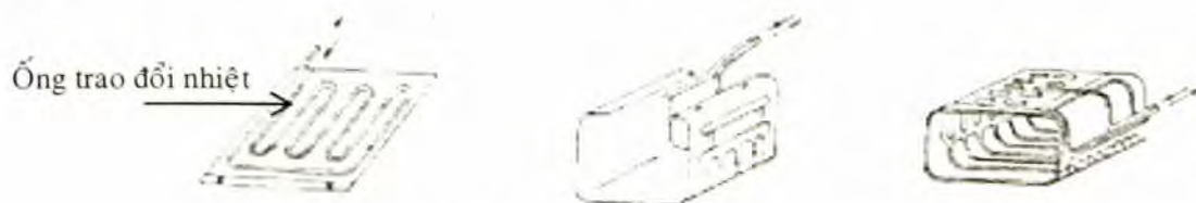
Hình 11.3: Cấu tạo dàn bay hơi
