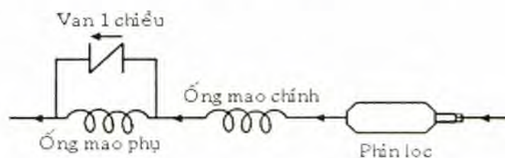
Hình 11.85: Sơ đồ giảm tải nhiệt bằng ống mao phụ
