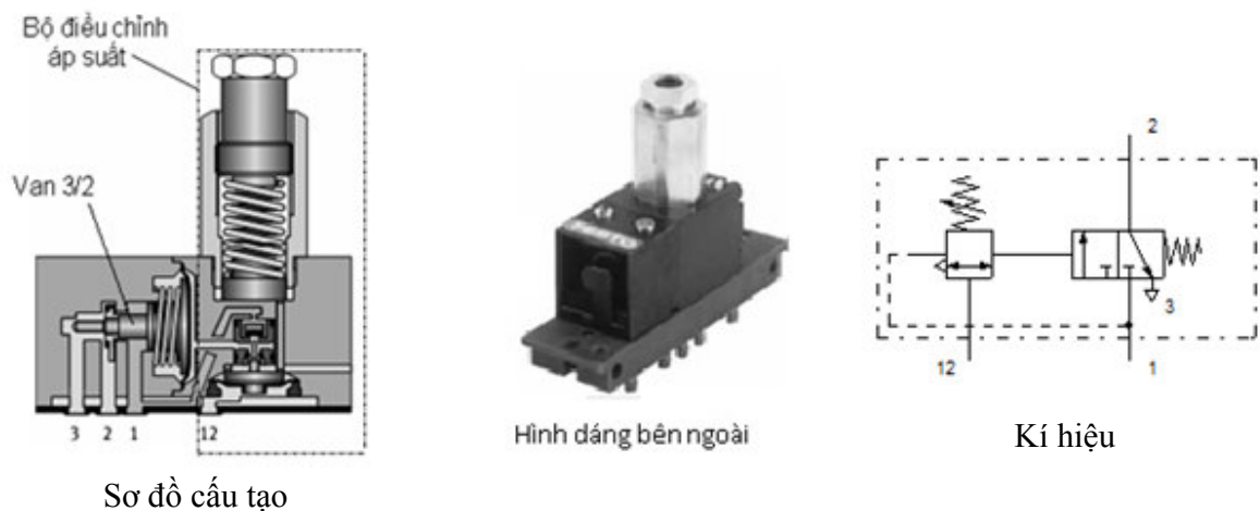
Hình 2.49 Van tuần tự áp suất
