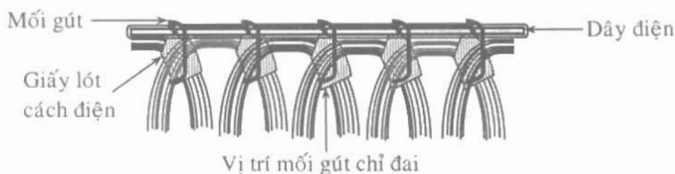
Hình 6.14. Cách lót bì cách điện đầu búi dây và đai dây
