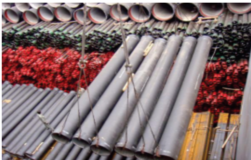
Hình 2.11. Hình minh họa quá trình cầu ống thép
