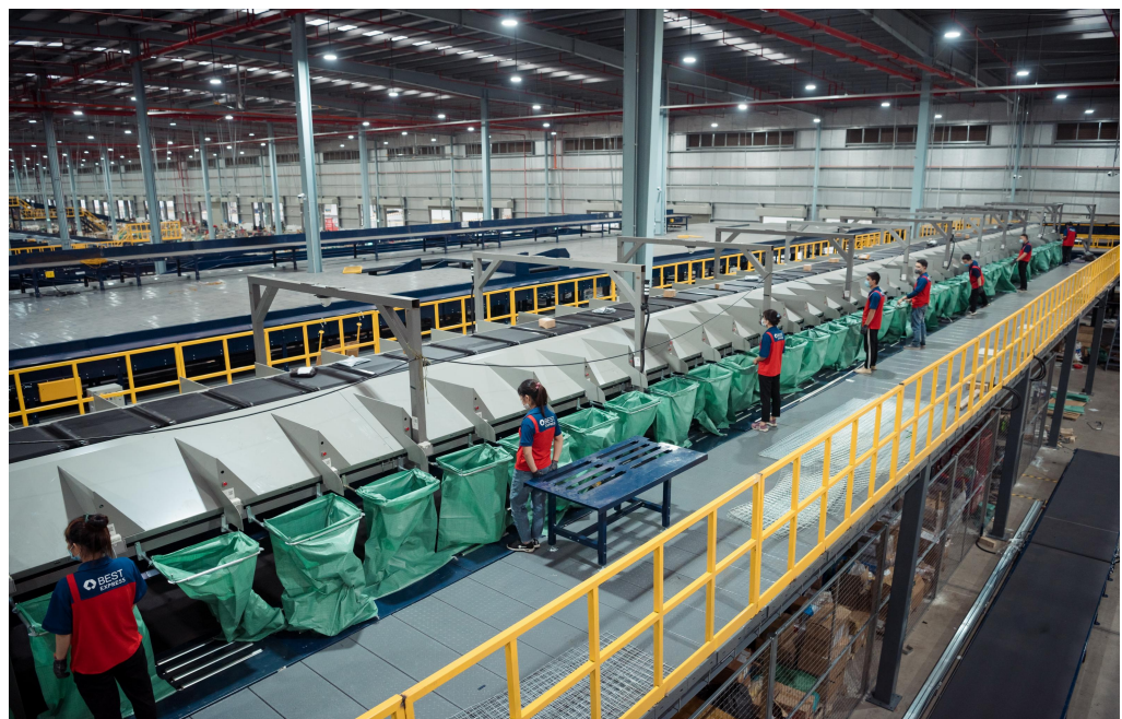
Hình 2.1. Hệ thống cân, đo tự động giúp tăng độ chính xác của việc phân loại bưu kiện
