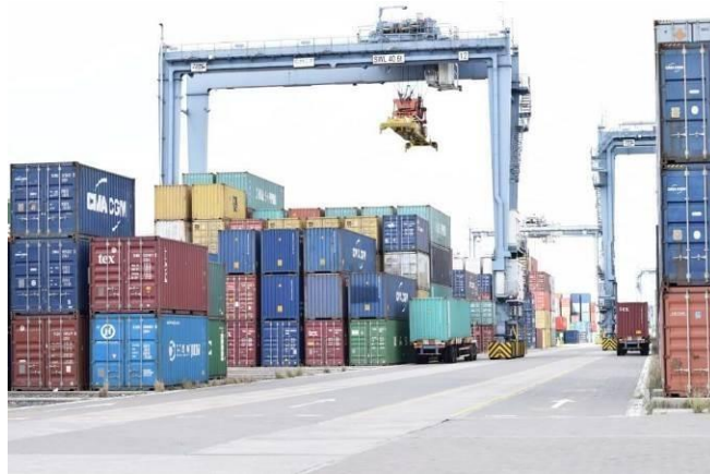
Hình 1.15. Cầu khung (RTG)
