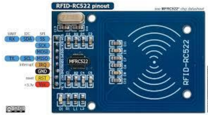
Hình 8: Thiết bị đọc RFID RC552
