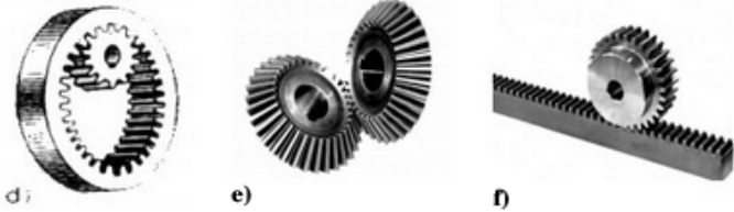
d) răng trong e) răng côn thẳng f) bánh răng – thanh răng
