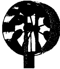
Hình 9.6: Đo tốc độ gió bằng đầu đo chong chóng.
