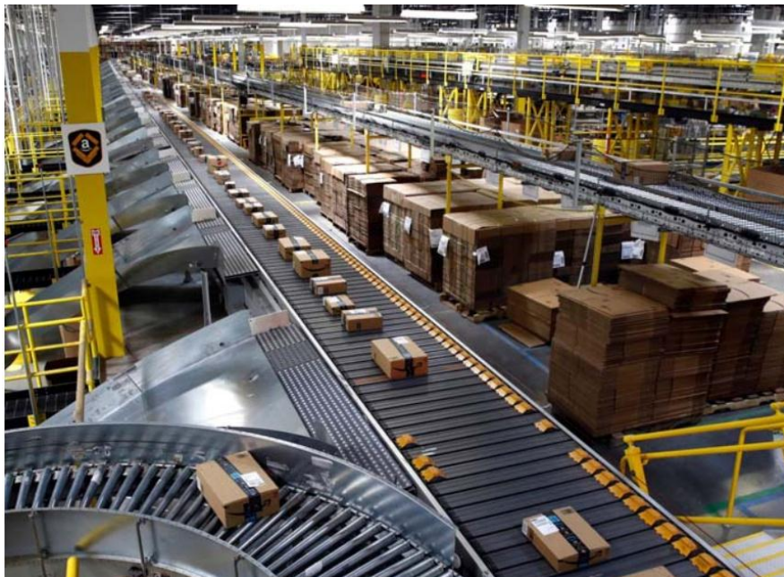
Hình 3.2: Lưu trữ hàng hóa thông minh bằng băng tải
